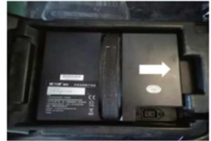
Akkuriegel entriegeln, Akkufachdeckel abnehmen, Akku in das Akkufach einsetzen, Akkustecker Richtung Rückseite links.
